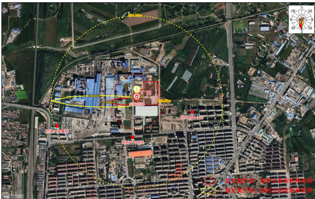
图 6-5 盐酸储罐泄漏氯化氢扩散影响范围
